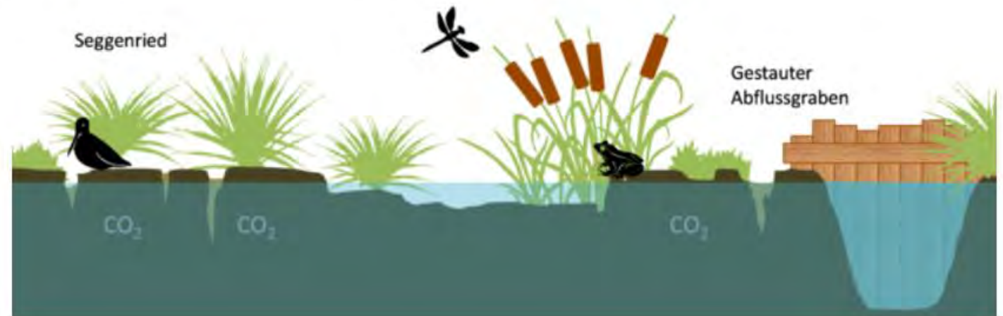
Schaubild eines durch den Aufstau des Entwässerungsgrabens wieder vernässten Moores
