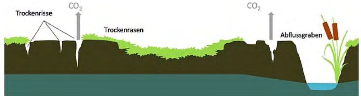
Schaubild eines mit einem Entwässerungsgraben trockengelegten Moores
